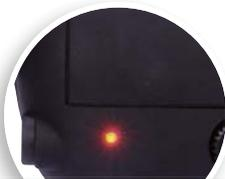
Led de indicación de batería en carga
